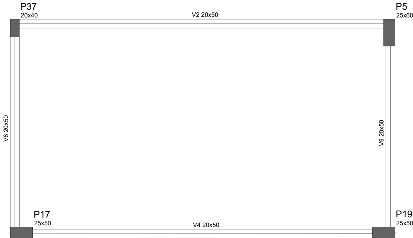
Forma do pavimento TAMPA RESERV escala 1:50
